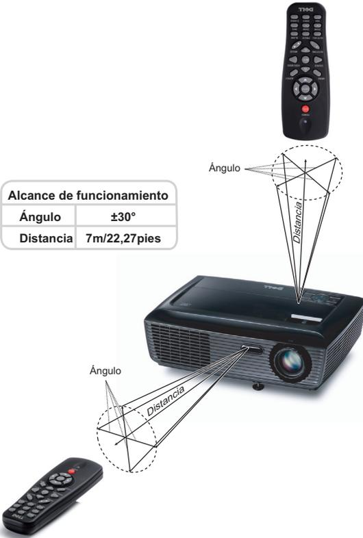
**NOTA:** El alcance de funcionamiento real puede ser ligeramente diferente al indicado en el diagrama. Las pilas gastadas también impedirán que el mando a distancia haga funcionar correctamente el proyector.
