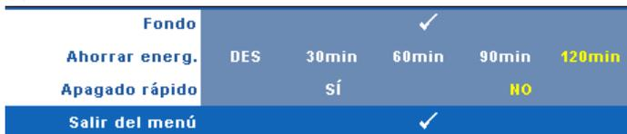
**AHORRAR ENERG.**—Seleccione **Des** para deshabilitar el modo de ahorro de energía. De forma predeterminada, el proyector se establece para entrar en el modo de ahorro de energía si transcurren 120 minutos sin actividad. Un mensaje de advertencia, en el que se muestra una cuenta atrás de 60 segundos, aparece en la pantalla antes de que el proyector pase al modo de ahorro de energía. Presione cualquier botón durante el periodo de cuenta atrás para detener el modo de ahorro de energía.
