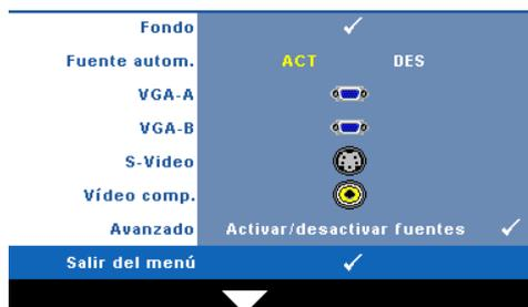
**FUENTE AUTOM.**—Seleccione **Desactivar** (valor predeterminado) para bloquear la señal de entrada actual. Si presiona el botón **Fuente** mientras el modo **Fuente automática** está establecido en **Desactivar**, podrá seleccionar manualmente la señal de entrada. Seleccione **Activar** para detectar automáticamente las señales de
